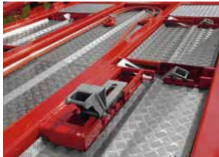
Versenk- & verstellbare Muldenansläge auf Unterbau mit tieferbesetzten Abdeckungen.
