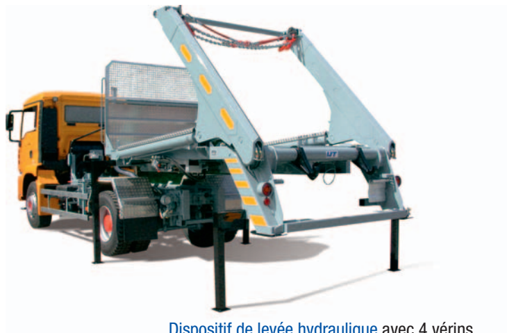
Dispositif de levée hydraulique avec 4 vérins pour soulever la superstructure
