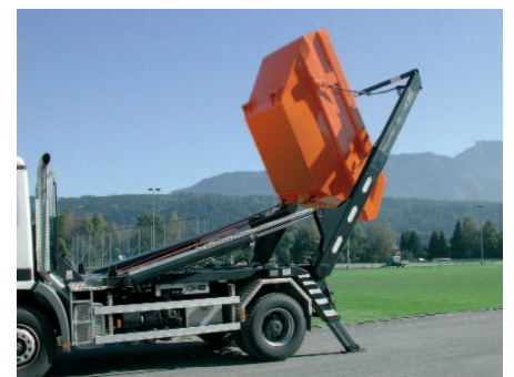
Butées de bennes escamotables / réglables sur structure avec protections abaissées
