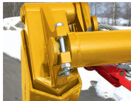
Bras principaux et télescopiques hexagonaux avec joug transversal
